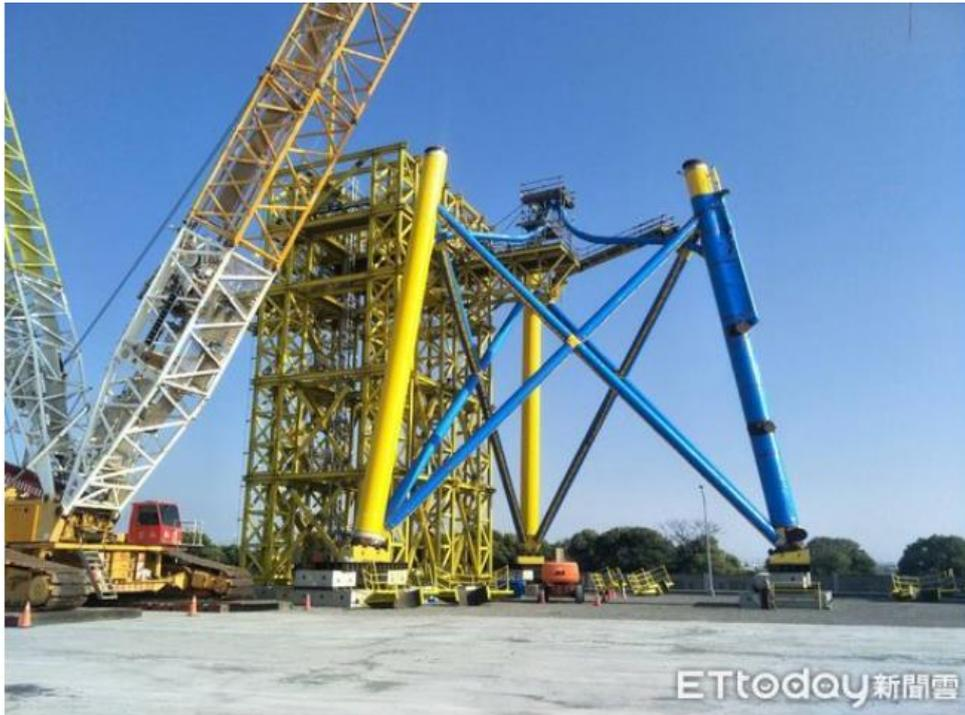
▲完成塗裝的水下風電座。(圖/台船防蝕提供)
